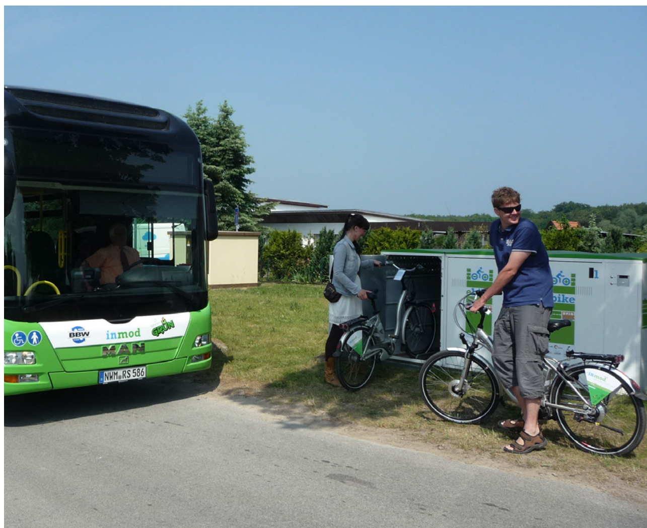
Modellprojekt „INMOD - elektromobil auf dem Land“ in Mecklenburg-Vorpommern: Hybridbus-Strecke mit Leih-Pedelec-Anbindung. Pedelecs sind aus Fahrradboxen mit Ladestation entnehmbar.
